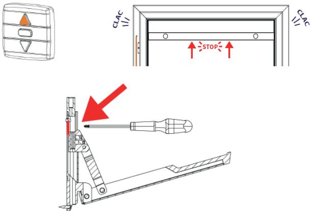
Appuyer sur le dispositif de sécurité à l'aide d'un tournevis pour déverrouiller le système.
